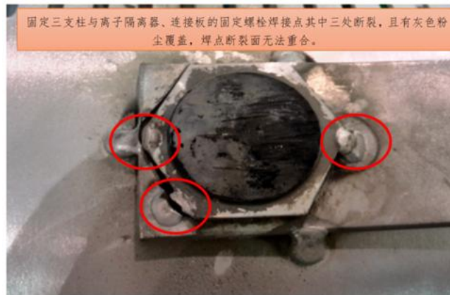
图 12 固定三支柱与离子隔离器、连接板的固定螺栓焊接点断裂
