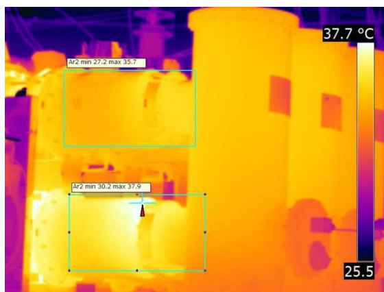
图 A.2 隔离开关动静触头接触不良引起发热
