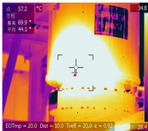
图 A.7 外置式 CT 防尘罩导流发热
